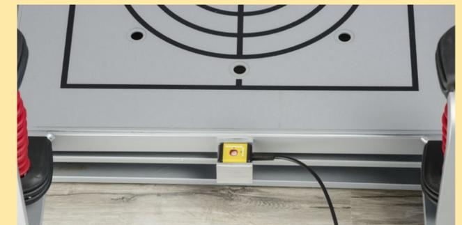
Abb.: Sensorbefestigung Posturomed<sup>®</sup> compact
