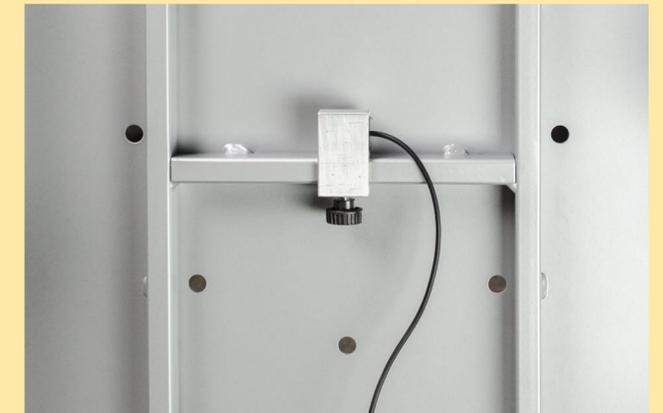
Abb.: Sensorbefestigung Posturomed<sup>®</sup> 202 (Unterseite)
