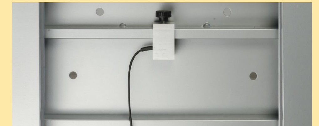
Abb.: Sensorbefestigung Posturomed® compact (Unterseite) – Achtung: Achsausrichtung einstellen!
