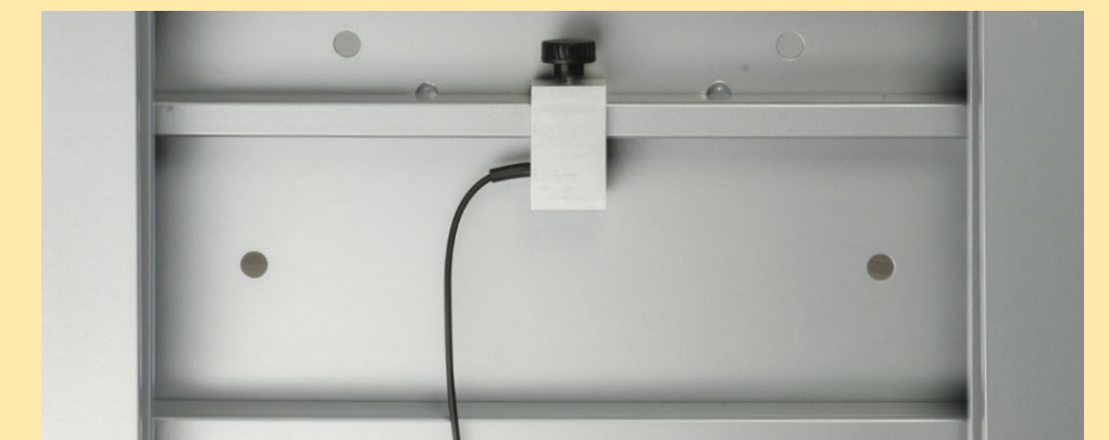
Abb.: Sensorbefestigung Posturomed® compact (Unterseite) – Achtung: Achsausrichtung einstellen!
