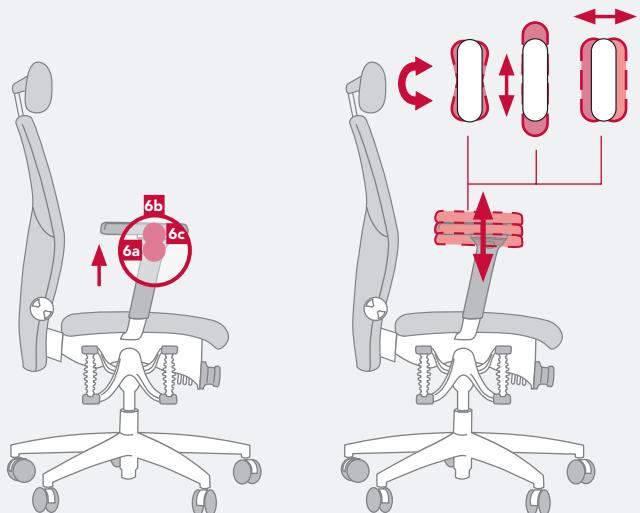
Zur Entlastung der Schulter- und Nackenmuskulatur können die Armlehnen in der Höhe eingestellt werden. Justieren Sie die Höhe so, dass Sie keine Anspannung in der Schulter spüren. Zusätzlich können die Armlehnenauflagen auf die jeweiligen Oberkörperproportionen in Breite und Tiefe angepasst, sowie hinsichtlich der Unterarmstellung in verschiedenste Positionen gebracht werden.
